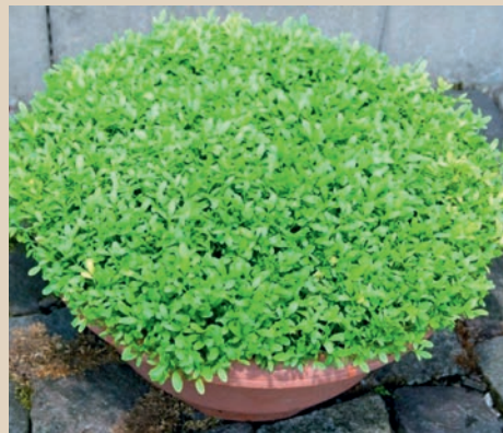
Der Kressetest zeigt die Reife des Komposts an
